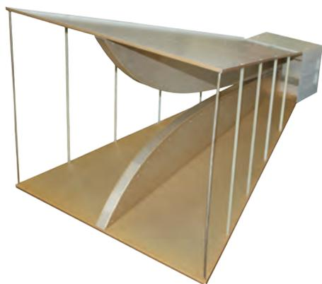
Сверхширокополосная измерительная рупорная антенна П6-160 на базе Н-образного волновода предназначена для приема и передачи линейно поляризованного сигнала в диапазоне частот от 180 МГц до 3 ГГц.
