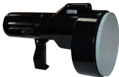
Широкополосная пассивная спиральная антенна П6-333 и широкополосная измерительная активно-пассивная антенная система П6-333М предназначены для приема сигналов круговой поляризации правого и левого вращения в диапазоне частот 0,5 - 26 ГГц. Антенная система П6-333М представляет собой антенну со встроенным малошумящим усилителем, для повышения чувствительности по полю измерительной системы.
