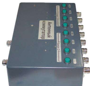
Антенный коммутатор диапазон частот от 0 до 26000 МГц предназначен для подключения к каждому из двух независимых приемных устройств (анализаторов спектра) до четырех различных антенн.
