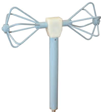
Широкополосная измерительная биконическая антенна П6-172 предназначена для приема и передачи линейно поляризованного сигнала в диапазоне частот от 300 до 1000 МГц.
