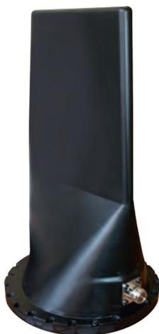
Широкополосная активная всенаправленная антенна AC3.200 на базе несимметричного излучателя предназначена для приема вертикально поляризованного сигнала в диапазоне частот от 3 до 3000 МГц.
